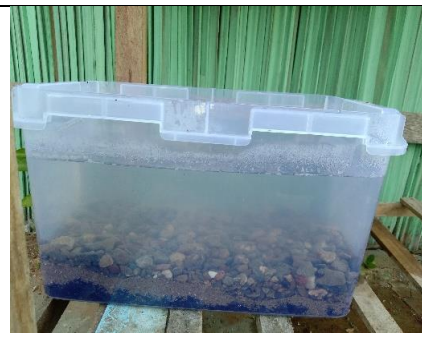
Gambar 4.6 Pengolahan Air Limbah Rumah Makan Hari 1 (Bak Kontrol)
