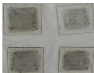
Elektroda lawan dilapisi dengan gravit pensil
