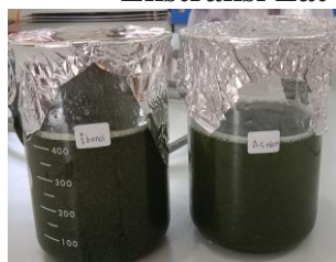
Proses maserasi dengan pelarut aseton dan etanol dilakukan selama 36 jam
