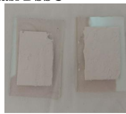
Hasil pasta TiO 2 di atas kaca ITO setelah di kalsinasi
