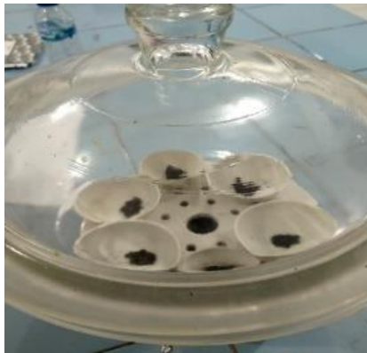
Proses pendinginan dalam desikator saat proses uji kimia (kadar abu, kadar abu dan kadar zat terbang)
