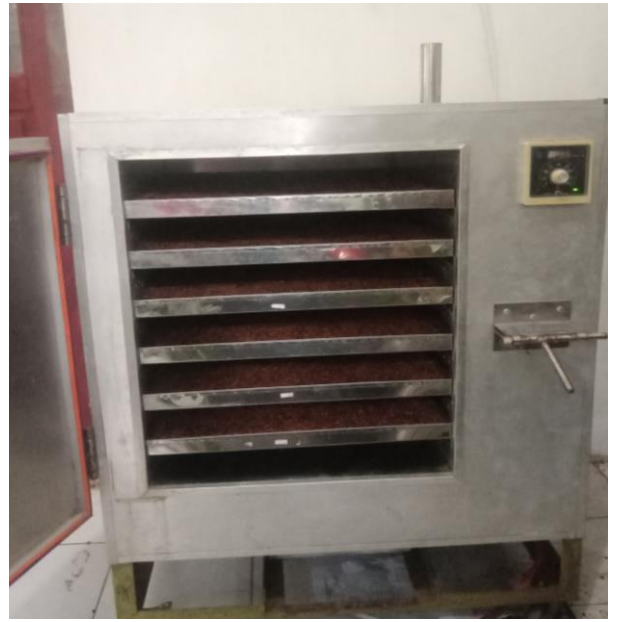
Pengeringan Biji Sorgum Menggunakan Cabinet Dryer
