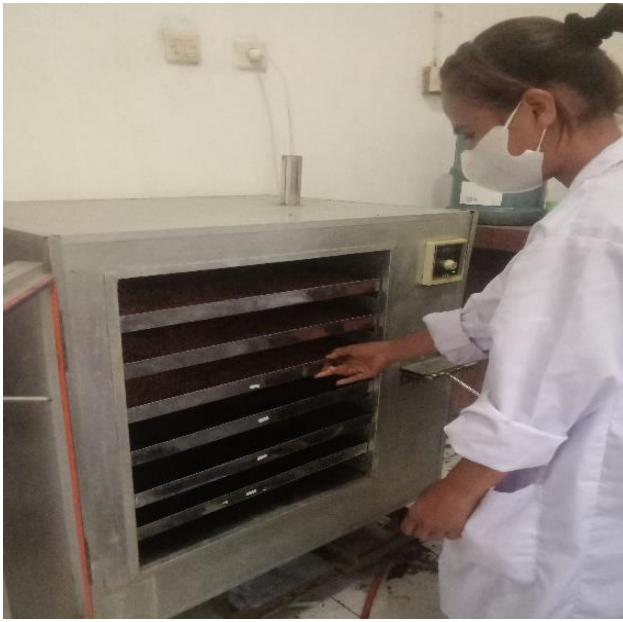
Pengeringan Biji Sorgum Menggunakan Cabinet Dryer
